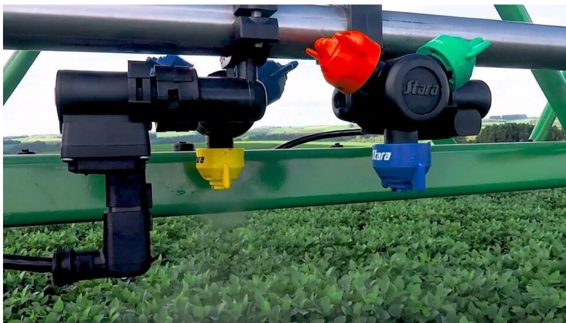
Figura 5. Sistema dupla linha da Stara®. ( www.stara.com.br )
