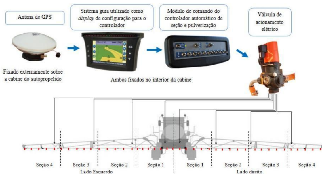
Figura 1. Principais partes que constituem um sistema de pulverização de precisão (REYNALDO & MOLIN, 2011).
