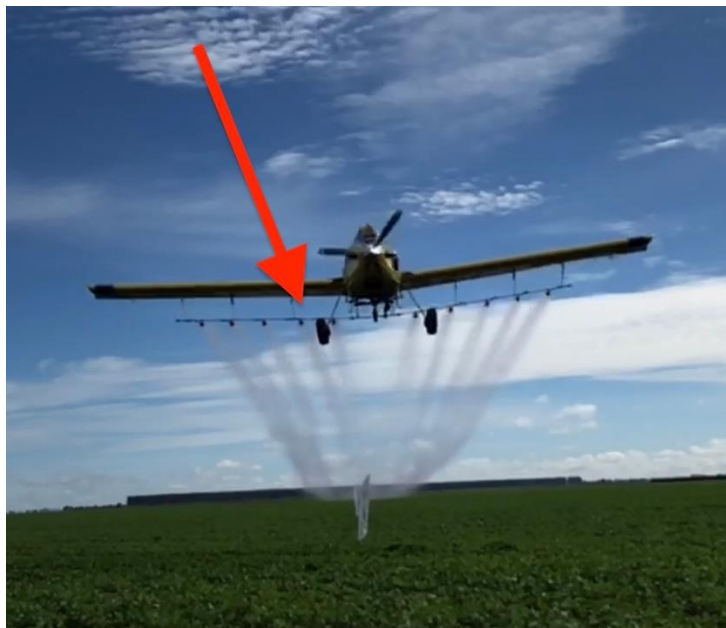
Foto 5: Aeronave Air Tractor 502 B com bico posicionado na região da raiz da asa direita sofrendo interferência do vortex da hélice
