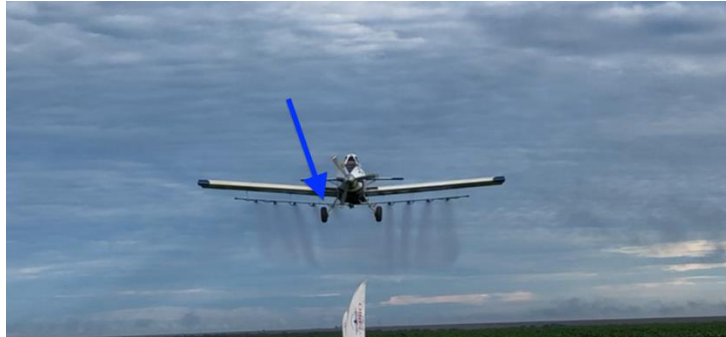
Foto 4: Aeronave Thrush 510 P com bico posicionado na região da raiz da asa direita sofrendo interferência do vortex da hélice
