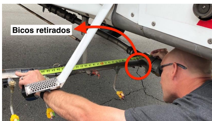
Foto 3: Foto ilustrativa de bicos fechados que estão posicionados nesta área de maior turbulência
