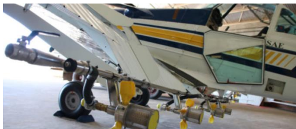
Foto 8: Foto demonstrativa de aeronave configurada com bicos rotativos com a barra de pulverização próxima das asas.
